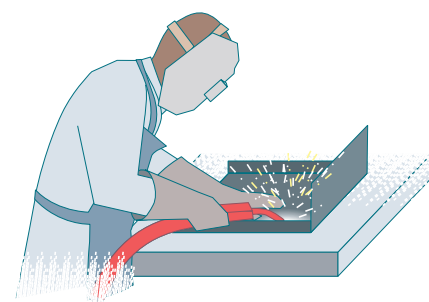
Fig. 4.1. Torche aspirante conçue pour minimiser la gêne lors de son utilisation.
