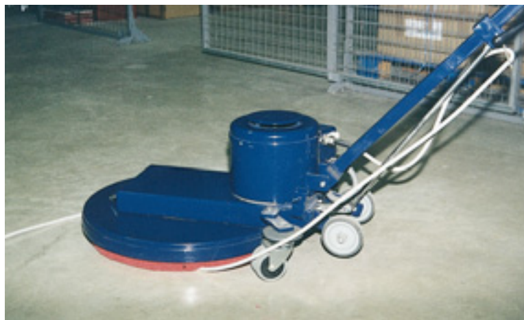
23. Fils passant sous une monobrosse : danger
